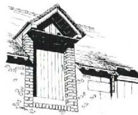
Grange à foin Muret de soulèvement. Essentage bois. Couverture en ardoise.
