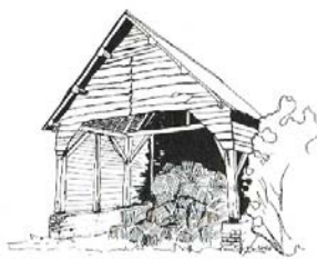
Grange à foin Muret de soulèvement. Essentage bois. Couverture en ardoise.
