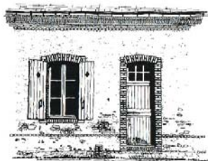
Utilisation de la brique dans l'habitat Entourage des ouvertures. Trottoir d'eaux pluviales. Corniche à l'égout de toiture.
