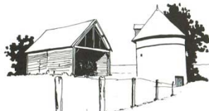
Annexes agricoles Une grange, essentage sur ossature bois. Un four à chanvre, construction circulaire. Une porte simple, un cerclage métallique de renfort.
