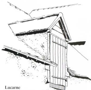
Lucarne Gerbière interrompant l'avant-toit. Ossature bois remplissage en torchis. Pentes identiques à celle de la couverture principale.
