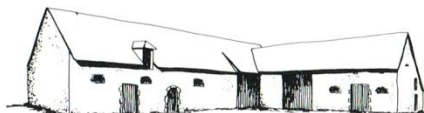
Cour de ferme Délimitation par des bâtiments à l'équerre. Dimensions des portes adaptées aux différentes fonctions. Ouvertures d'aération demi-circulaire.
